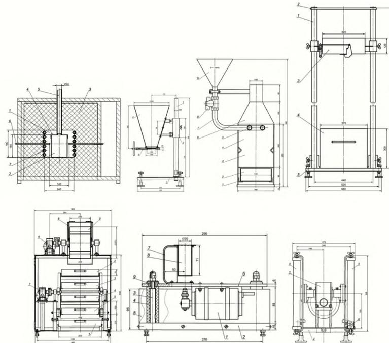
Установка предназначена для оценки коксующести углей и их смесей (шихт) по ГОСТ 9521 «Угли каменные. Метод определения коксующести». Установка позволяет определить возможность получения кокса из углей и их смесей и определить показатели его **механической** ( $P_{25}$ ,  $P_{10}$ ) и **структурной прочности** ( $P_c$ ).
